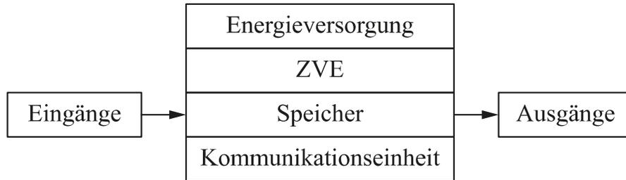
Abbildung 21: Aufbau einer SPS
