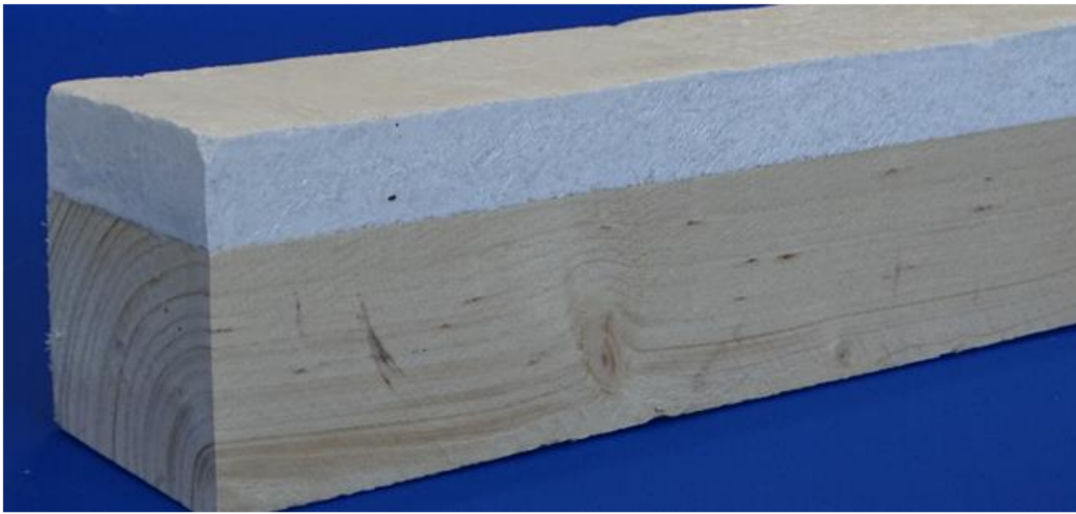
Bild 1: Verbund aus Holz und dem entwickelten Material, welches fast beliebig einfärbbar ist
