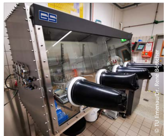
Außenansicht der für das Projekt ProAlu/SKAIL aufgestellten Handschuhbox zur Abscheidung von Aluminiumlegierungen aus ionischen Flüssigkeiten.
