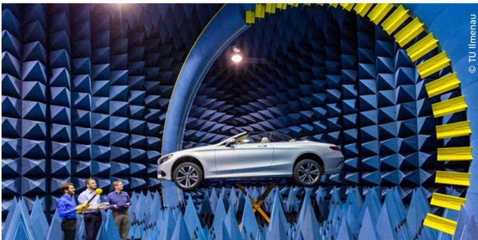
Durchführung von Messungen in der VISTA (Virtuelle Straße Simulations- und Testanlage) des ThIMo (Thüringer Innovationszentrum Mobilität)
