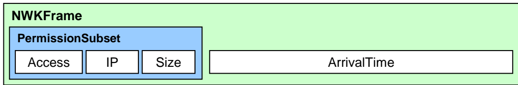
Abbildung 4-34: Aufbau der NWKFrame-Datenstruktur mit Permission
