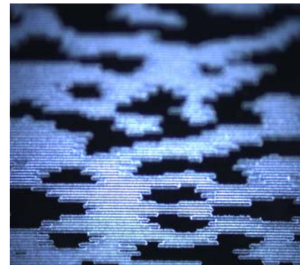
Abb. 3: Mit ps-Laserpulsen erzeugte Struktur in Quarzglas (Periode = 14 \mu\text{m} .)
