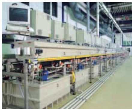
Bandanlage Collini Biel, reel-to-reel-Beschichtung von Steckern und elektronischen Bauteilen
