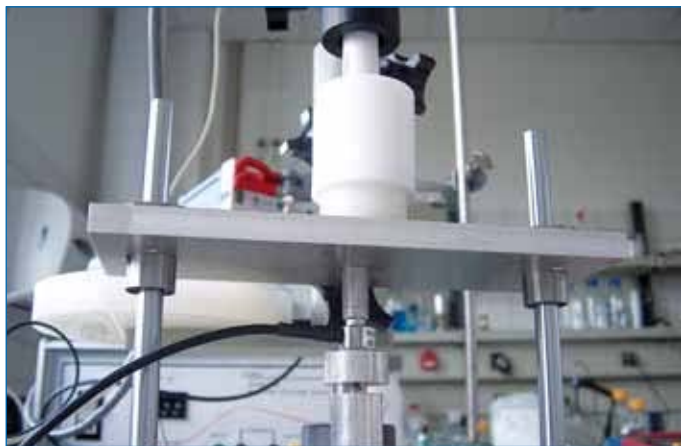
Poliereinrichtung zum Polieren der auf dem Schwingquarz abge- schiedenen Kupferschichten
