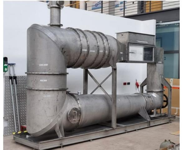
**Ziel:** Ziel ist die zuverlässige Charakterisierung des kompletten Strömungsfeldes in der Messstrecke mittels Particle Image Velocimetry für unterschiedliche Betriebspunkte, die Erstellung einer Kanalkalibrierkurve und die Bewertung des Turbulenzgrades.
