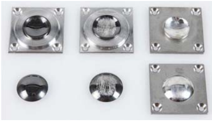
Abb. 1: Vergleich herkömmlicher Bandscheibenimplantate und mit Tantal beschichteter Implantate nach mehreren Jahrzehnten Nutzung [17]
