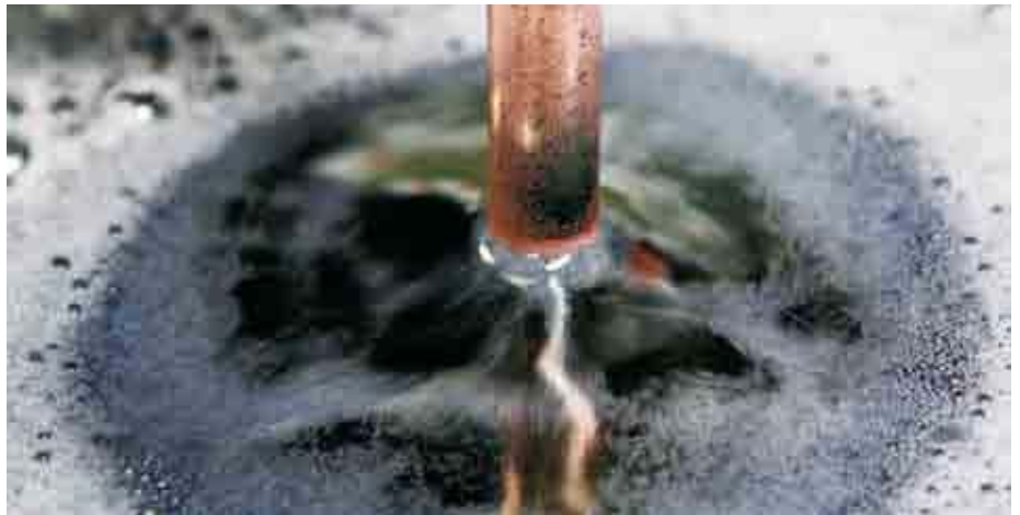
Wasserstoffentwicklung an einer Kupferkathode in einem Cr(III)-Elektrolyten
