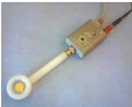
Für Elektrolytsysteme ist eine Quarzmikrowaage in Form einer Sonde von Vorteil.
