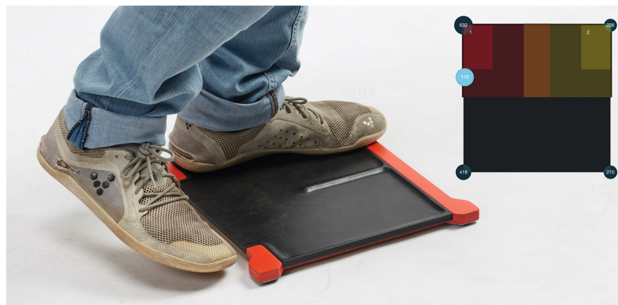
Bild 2: Eine GUI macht den Schwerpunkt sichtbar
