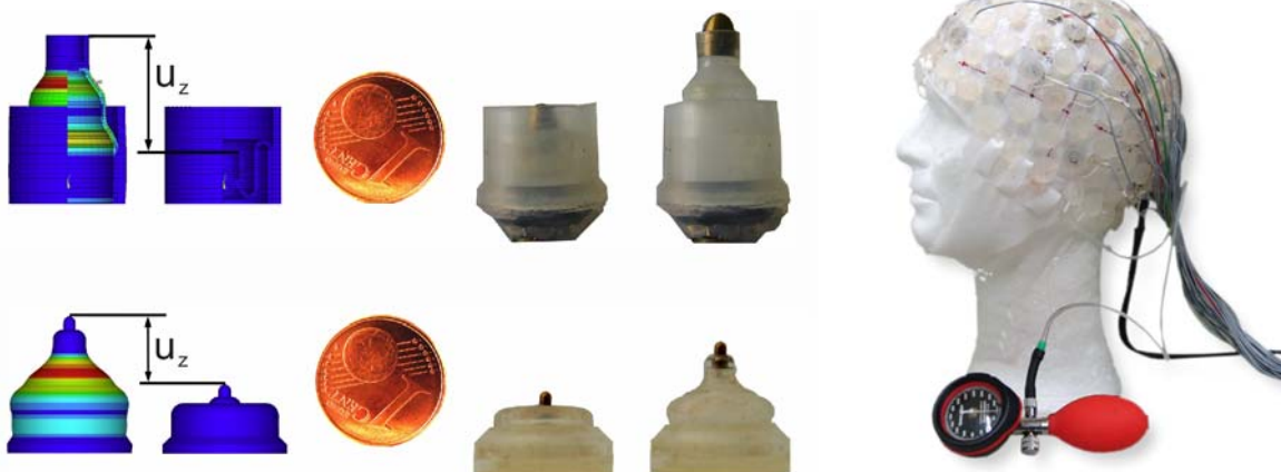
Abb.: Simulation fluidmechanischer Aktuatoren und gefertigte Funktionsmuster mit und ohne Innendruck, nachgiebige EEG Haube mit fluidmechanischen Aktuatoren zur Elektrodenpositionierung
