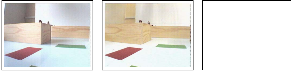
Abbildung 3: Szenario mit Hindernissen; die roten Landmarken kennzeichnen Sackgassen, die grünen günstige Wege (links). Durch Schattenwürfe entstehen Helligkeitsschwankungen im Kamerabild (rechts).
