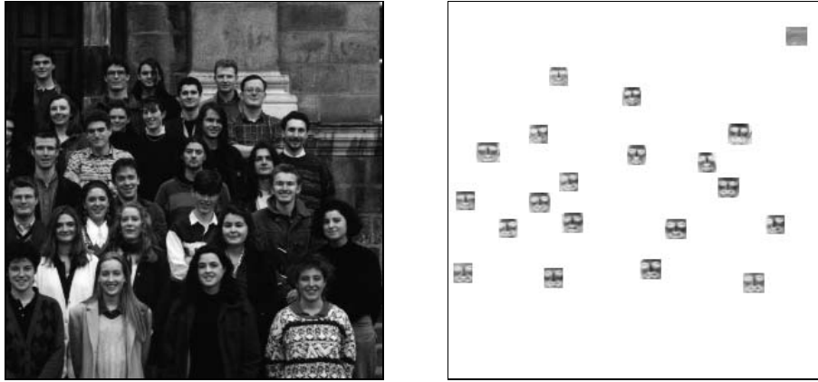
Abbildung 6. Ergebnis der strukturbasierten Gesichtsdetektion; es wurde jeweils dort die Maske eingeblendet (invertiert), wo mit einer hohen Wahrscheinlichkeit ( >0.7 ) ein Gesicht detektiert wurde
