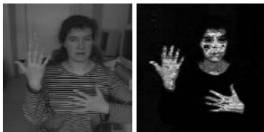
Abb. 3. Grauwertbild der zu analysierenden Farbszene (links) und Ergebnis der Farbpixelbewertung eines neuronalen Hautdetektors (rechts). Das Hypothesenbild wird dem columnaren Feld zur formerhaltenden sequentiellen Aufmerksamkeit präsentiert.
