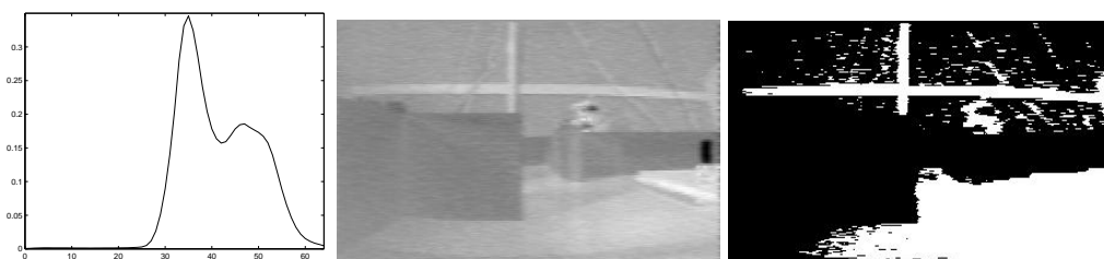
Abbildung 3: Links: LIdU über die gesamte untere Bildhälfte mit dem lokalen Minimum \eta = 42 . Mitte: Transformiertes Kamerabild im Blau-Gelb-Farbband. Rechts: Das binarisierte Bild. Der freie Bereich auf der rechten Seite ist klar erkennbar, wegen auftretender Abschattungseffekte sind die Ränder zu den Hindernissen zerfranst.
