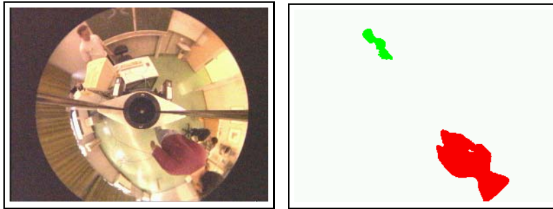
Abb. 8. Beispiel für die Bewegungsdetektion im Bild der Omnikamera; links: Originalbild der Einsatzumgebung; rechts: bewegungsbasiert segmentierte Regionen, in denen sich eine Person befindet bzw. befinden könnte
