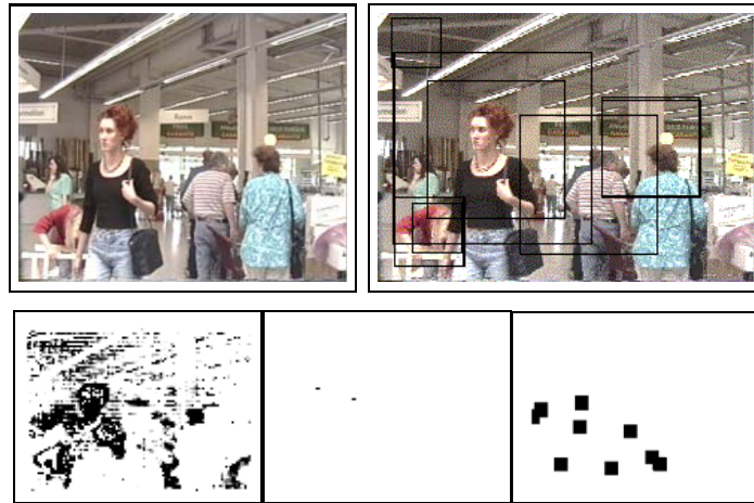
Abb. 7. Lokalisierungsergebnis in einer Szene aus der realen Baumarkt-Umgebung: oben links das Originalbild und rechts die Regionen, für die nach der Cue-Fusion eine starke Hypothese für das Vorhandensein einer Person vorliegt; deutlich sichtbar sind neben den eigentlichen Personenregionen weitere Hypothesen, die sich nahezu zwangsläufig aufgrund der Szenenstruktur ergeben; unten v.l.n.r. exemplarisch die Ausgaben der Cue-Module für Hautfarbe, Silhouette und Gesichtsstruktur für die erste Ebene (höchste Auflösung) der Multiskalenrepräsentation
