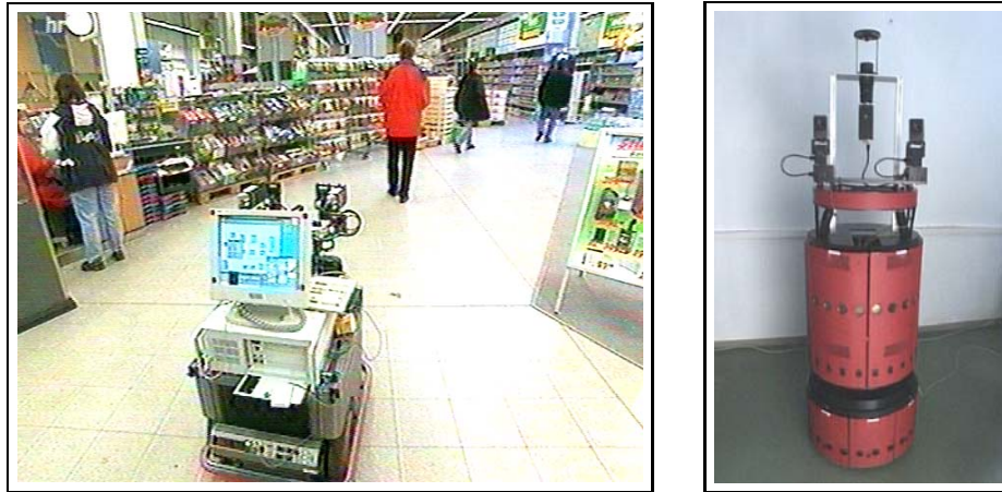
Abb. 2. Links: MILVA, eine Plattform mit Dreiradkinematik, Front(Navigations)kamera, Doppelkamarasystem mit PTU's und schwenkbarem „Hals“, Stereomikrofonanordnung, Laserscanner, Bumperleiste Rechts: PERSES, eine B21-Plattform (RWII, USA) mit Ultraschallsensorik, Stereokamerasystem und Omnikamera
