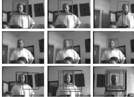
Abb. 8. Ausschnitte aus einer mehrmütigen Trackingsequenz (die Rahmen indizieren die wahrscheinlichste Position des zu verfolgenden Objekts). Der Trackingprozess ist derzeit noch beschränkt auf Personen, die sich dem Roboter in etwa frontal zuwenden.
