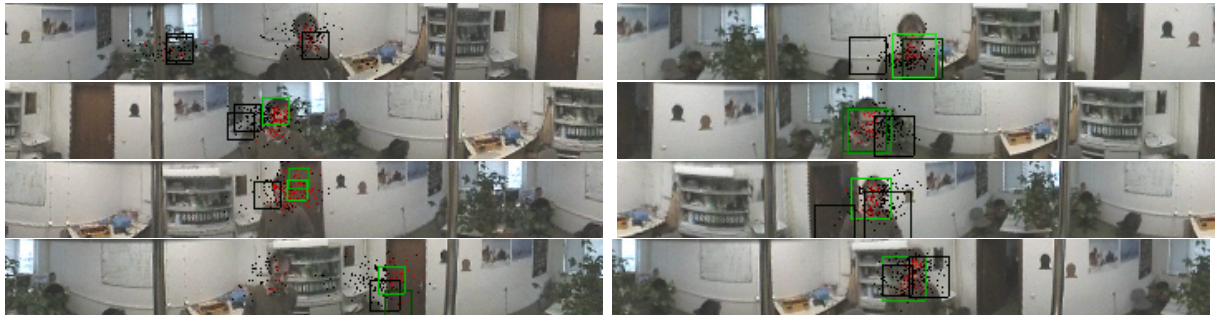
Abbildung 5: Gegenüberstellung von rein visuellem Tracking (links) und sonar-unterstütztem Tracking (rechts). Es wird nur jedes zehnte Bild der Sequenz dargestellt (die Zeitachse verläuft von oben nach unten); der Nutzer bewegt sich ein mal um den Roboter. Der Roboter dreht sich sonarbasiert mit. Während beim ausschließlich visuellen Tracking viele Samples an der Tür hängenbleiben (hautfarbähnlich), verliert das Verfahren mit Sonar-Unterstützung den Nutzer nicht.
