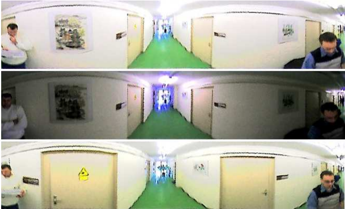
Abbildung 4: Drei Aufnahmen in einem gangartigen Bereich ähnlich dem späteren Einsatzfeld zur Untersuchung der Merkmale; Oben und Mitte identische Position aber unterschiedliche Beleuchtung; Oben und Unten identische Beleuchtung aber unterschiedliche Positionen (ca. 1,5 Meter von einander entfernt)
