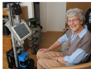
Abbildung 2: Die genutzte Hardware Plattform ist ein Pioneer-Roboter mit einem zusätzlichen Aufbau zur Interaktion: Tablet-PC, Robotergesicht und Kameras. Die Interaktion mit den Nutzern erfolgt über den Tablet-PC. Einen besonderen Aspekt der Kennenlernphase bildete die Einführung einer eher technisch anmutenden Forschungsplattform.
