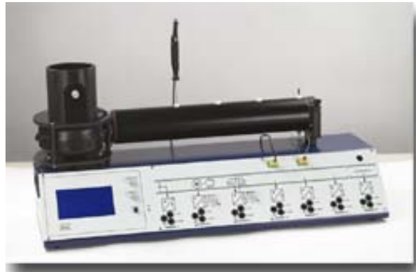
Abbildung 1: Luftstrom- und Temperaturregelstrecke LTR701 (Bildquelle: www.amira.de)
