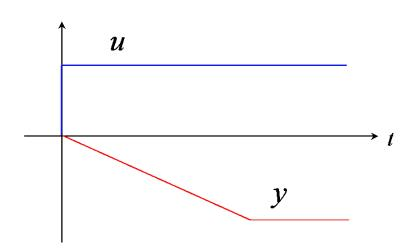
Es zeigt ein Integrationsverhalten. Das System muss stabilisiert werden!
