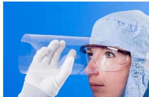
Glas mit einer Dicke unter 100 \mu\text{m} ist flexibel
