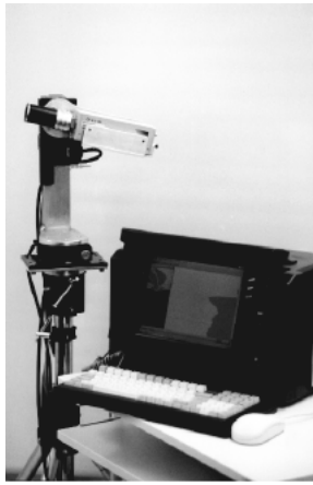
Abb. 1: Photo und Funktionsprinzip des Leuchtdichteanalysators der TU Ilmenau
