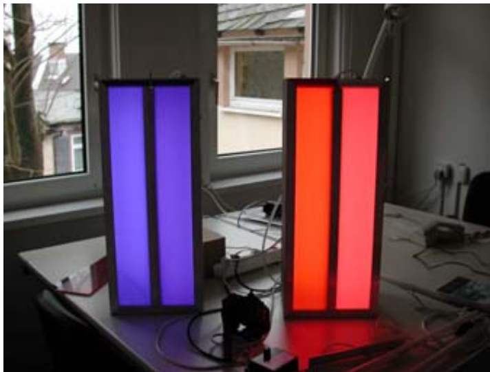
Bild 2 Dimmbare Hochspannungsleuchtröhren im Gehäuse mit Plexiglasscheiben
