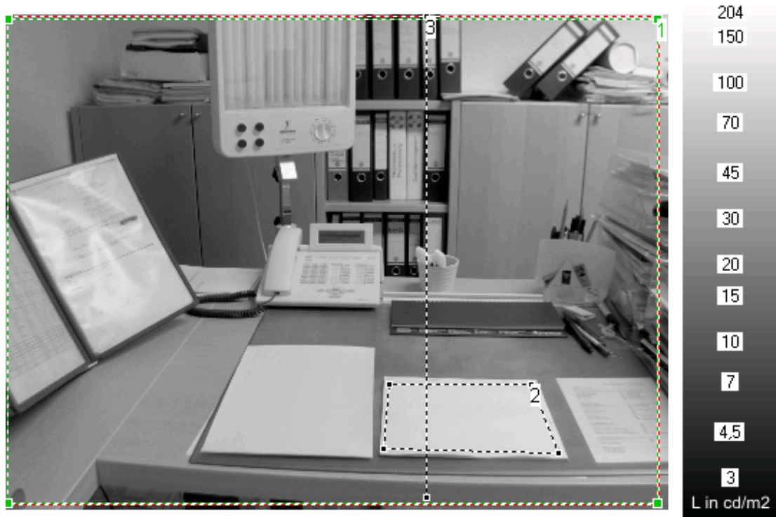
Abb. 5: Verteilung der Leuchtdichte im Arbeitsbereich (Büro 1)
