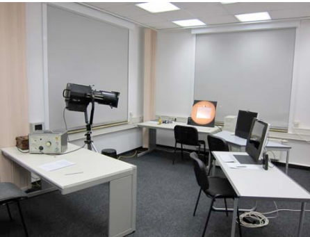
Abb. 3: Versuchsaufbau zur Untersuchung der diffusen Reflexion in Ilmenau
