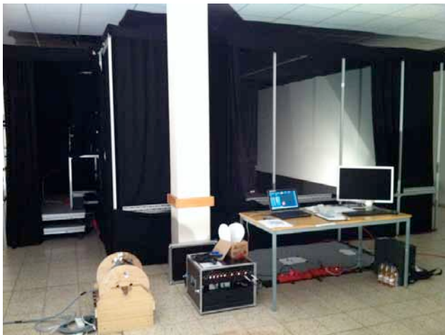
Abb. 2: Laboraufbau zur Untersuchung des Schwellenleuchtdichteunterschieds
