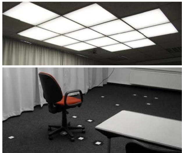
Abbildung 2: Bestückung und Anordnung der Leuchten im Testfeld (links) und Blick auf das Leuchtentestfeld (rechts, oben) und die Beobachterpositionen im Versuchsraum (rechts, unten)
