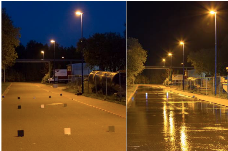
Abb. 1: Trockene und bewässerte Straße mit Sehobjekten unterschiedlichen Reflexionsgrades. Auf der nassen Straße sind typische Reflexbilder der Leuchten zu erkennen.
