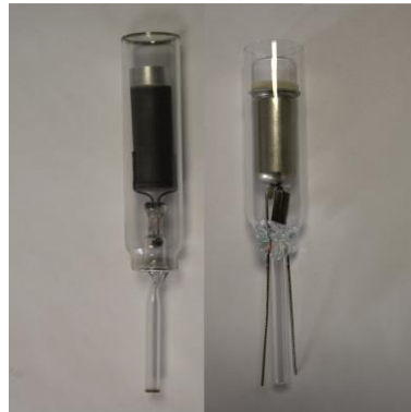
Abb. 4.: Elektroden im Vergleich, links Reinst Eisen; rechts moderne Elektrode mit Hg-Kapillaren
