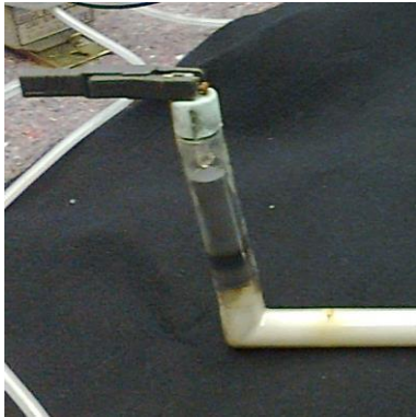
Abb. 3.: Reinsteisenelektrode an einem System aus dem Bestand während der colorimetrischen Messungen
