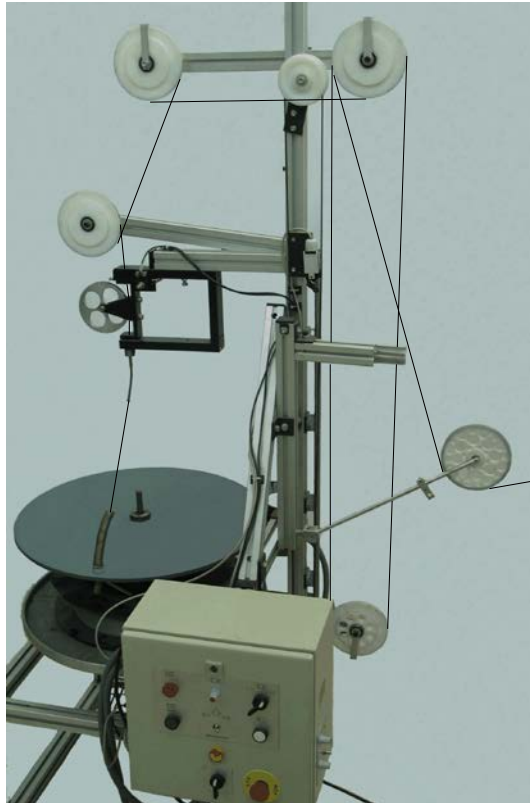
Bild 7: Prinzip der Drahtzuführung mit Drahtzugregelung am Beispiel des Funktionsmusters ADH
