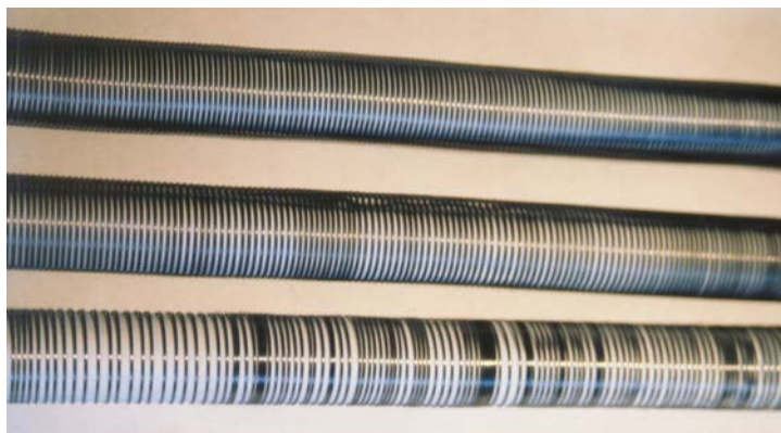
Bild 2: „Lange Federn“ aus gleichmäßigem Draht (oben), mittelmäßigem Draht (Mitte) und ungleichmäßigem Draht (unten), Drahtdurchmesser d = 0,4 mm
