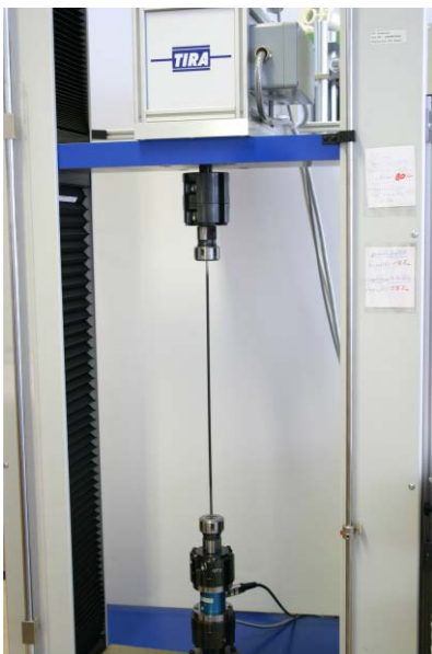
Bild 1: Prototyp eines Torsionsprüfstandes der Firma TIRA
