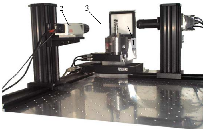
Bild 2: Bildverarbeitungsmessplatz zum automatischen Bestimmen des Windungsdurchmessers und des Windungsverlaufes 1 – Zeilenkamera, 2 – Matrixkamera, 3 – Federaufnahmedorn
