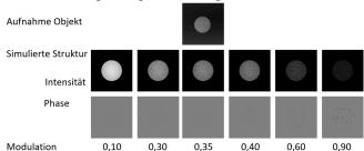
Des Weiteren stellt die hohe Hintergrundintensität bei der Untersuchung von Phasenobjekten eine große Herausforderung dar. Anhand von Simulationen (Vorgabe eines Phasenobjekts sowie Probe mit Speckle) ist zu untersuchen, ob und unter welchen Bedingungen ein Herausrechnen des DC Bias (=heller Hintergrund) vor dem Algorithmus (preprocessing) oder nach erfolgtem Algorithmus (postprocessing) günstiger ist.
