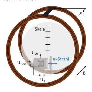
In einem Fadenstrahlrohr (siehe Abb.) entstehen durch Glühemission Elektronen an der Kathode innerhalb des negativ geladenen Wehneltzylinders. Durch eine hohe positive Spannung  $U_{\rm B}$  werden die Elektronen zur Anode hin beschleunigt und treten dort durch eine lochartige Öffnung als Elektronenstrahl aus. Die Geschwindigkeit der Elektronen ergibt sich aus dem Energieerhaltungssatz zu:
