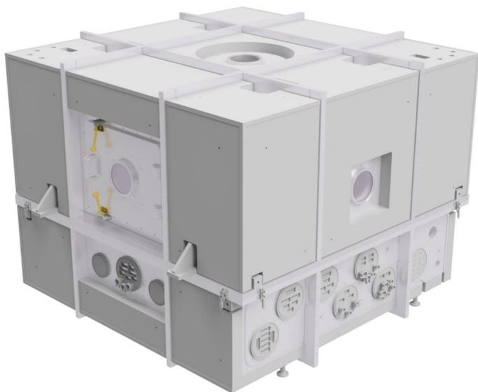
**Abb. 1:** Beispielanwendung: abgeschlossene Messkammer der Nanopositionier- und Nanomessmaschine NPMM-200 der TU Ilmenau. Kammervolumen:  $2.7m^3$
