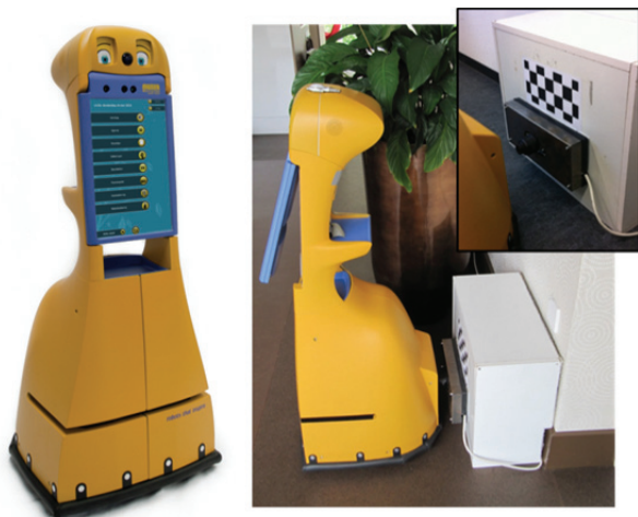
Abbildung 2 links: Scitos G3, entwickelt als Assistenzroboter für CompanionAble. rechts: der Roboter angedockt an der Ladestation sowie Großaufnahme der Ladestation
