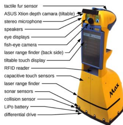
Abbildung 1: Die in SERROGA genutzte mobile Roboterplattform Scitos G3 mit erweiterter Sensorik.
