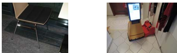
Abbildung 4: Zwei Hindernisse, die in den Funktionstests nicht sicher über die Robotersensorik erkannt wurden, so dass Kollisionen auftraten.
