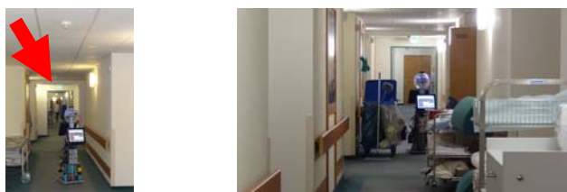
Abbildung 8: Beispielhafte Situationen, die eine Engstellenerkennung erfordern, wie z.B. eine Flurverengung durch eine integrierte Tür (links) oder auch Service- und Reinigungswagen sowie geöffnete Zimmertüren (rechts).
