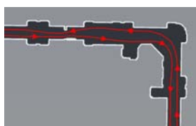
Abbildung 9: Visualisierung eines Ausschnitts einer Robotertrajektorie unter Nutzung des Rechtsfahrverhaltens während einer kompletten Rundfahrt durch den Gang. Es ist erkennbar, dass sich der Roboter auf der Hin- und Rückfahrt jeweils näher an der in Fahrtrichtung rechten Wand befindet.
