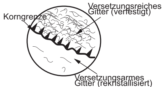
Bild 5: Umbau eines fehlgeordneten Gitters in ein fehlerarmes durch eine wandernde Korngränze
