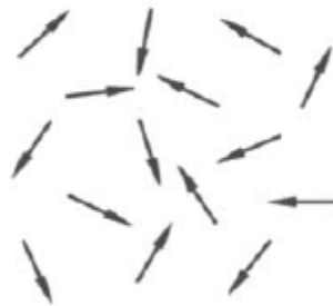
Abb. 1: Schematische Darstellung der regellosen Ausrichtung der atomaren magnetischen Momente beim Paramagnetismus
