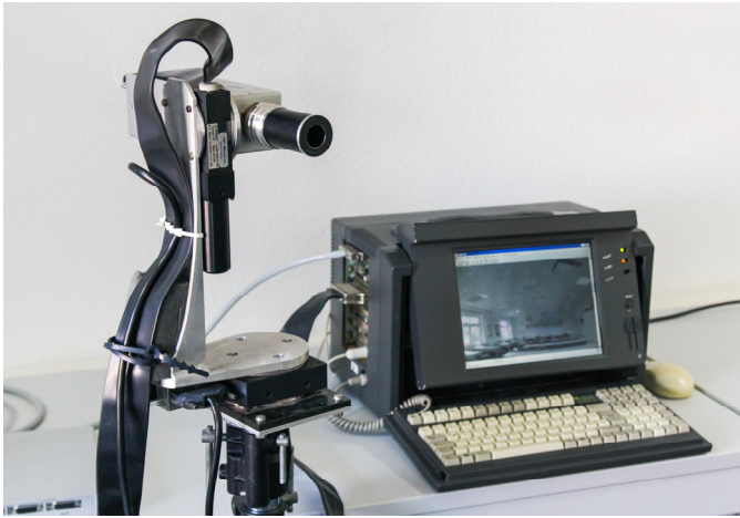
Bild 8: Am Fachgebiet Lichttechnik entwickeltes UGR-Messgerät zur Bewertung der Blendung von Leuchten
