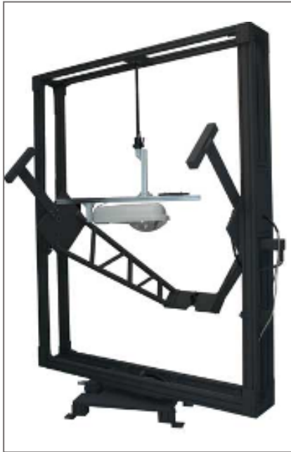
Bild 6: Goniophotometer nach Riemann (RiGO)
