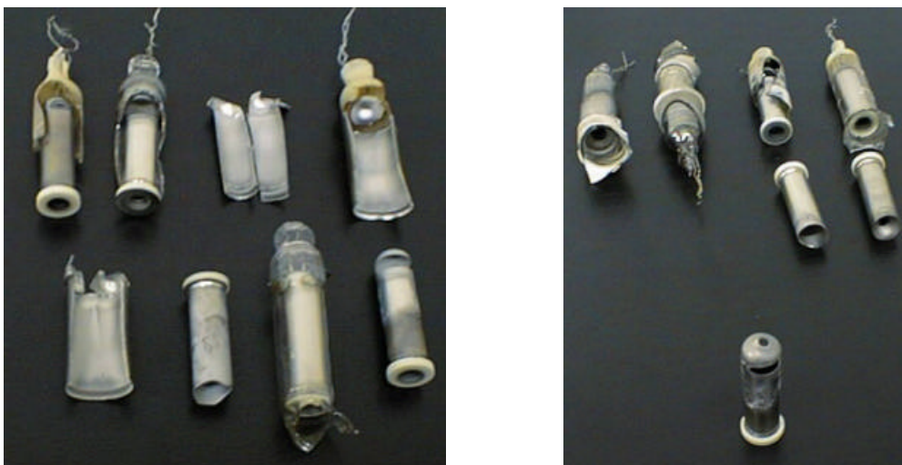
Bild 1 Typische Zerstörungsbilder ausgefallener Hochspannungsleuchtröhren
