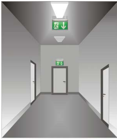
Abbildung 10: Situation 2 nach DIN EN 1838 (Elektrisch betriebenes Sicherheitsleitsystem).
