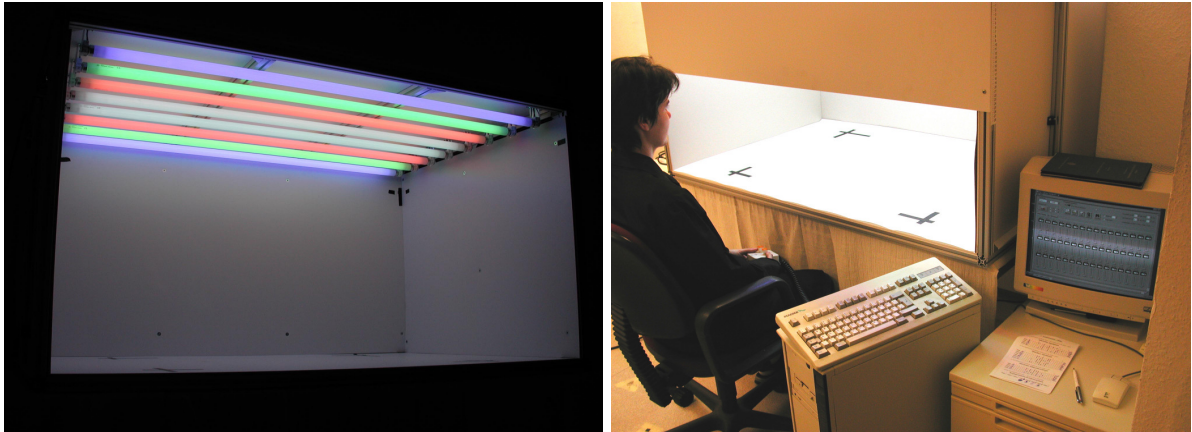
Abbildung 2: Aufbau und Einsatz des Lichtsimulators
