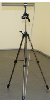
Abb. 2.1: Abschattungsrohr auf Dreibeinstativ
